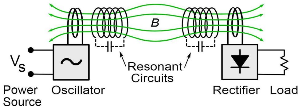
因此主線圈便可運用諧振的模式產生能傳遞更遠的磁場(綠色)，當副線圈的自然諧振頻率跟主線圈產生的磁場頻率相同時，便可容易地被激化，並與主線圈產生同步諧振狀態，進而形成一個“諧振通道”，將接收到的磁場轉為可用的電能(Q 值越高=阻尼越低的線圈，越能將接收到的磁場能量保存住並使用之)。反觀磁感應無線傳電技術雖然也稱為“無線傳電”，但當主線圈與副線圈的距離增大或沒對準時，耦合效率就會急速下降(或降為零)，導致無法有效傳電(主線圈與副線圈之間的耦合係數=K 值， $0 < K < 1$ ，當  $K=1=100%$  耦合，當距離越大或越沒對準時 K 值就越小)。磁共振無線傳電技術針對這樣的問題，使用了增高 Q 值的方法來提升整體傳電效率。因為磁共振無線傳電技術之傳電效率計算公式是以 K 與 Q 乘數為基礎的函數。當 K 與 Q 乘數為基礎的值越大時傳電效率的計算函數值就越大因此傳電效率的計算公式就會產生越大的效率值！
